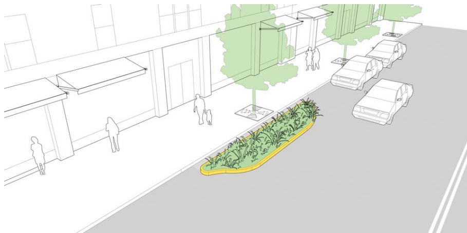
58. attēls. Brauktuves sašaurināšana un apstādījumu bagātināšana.
