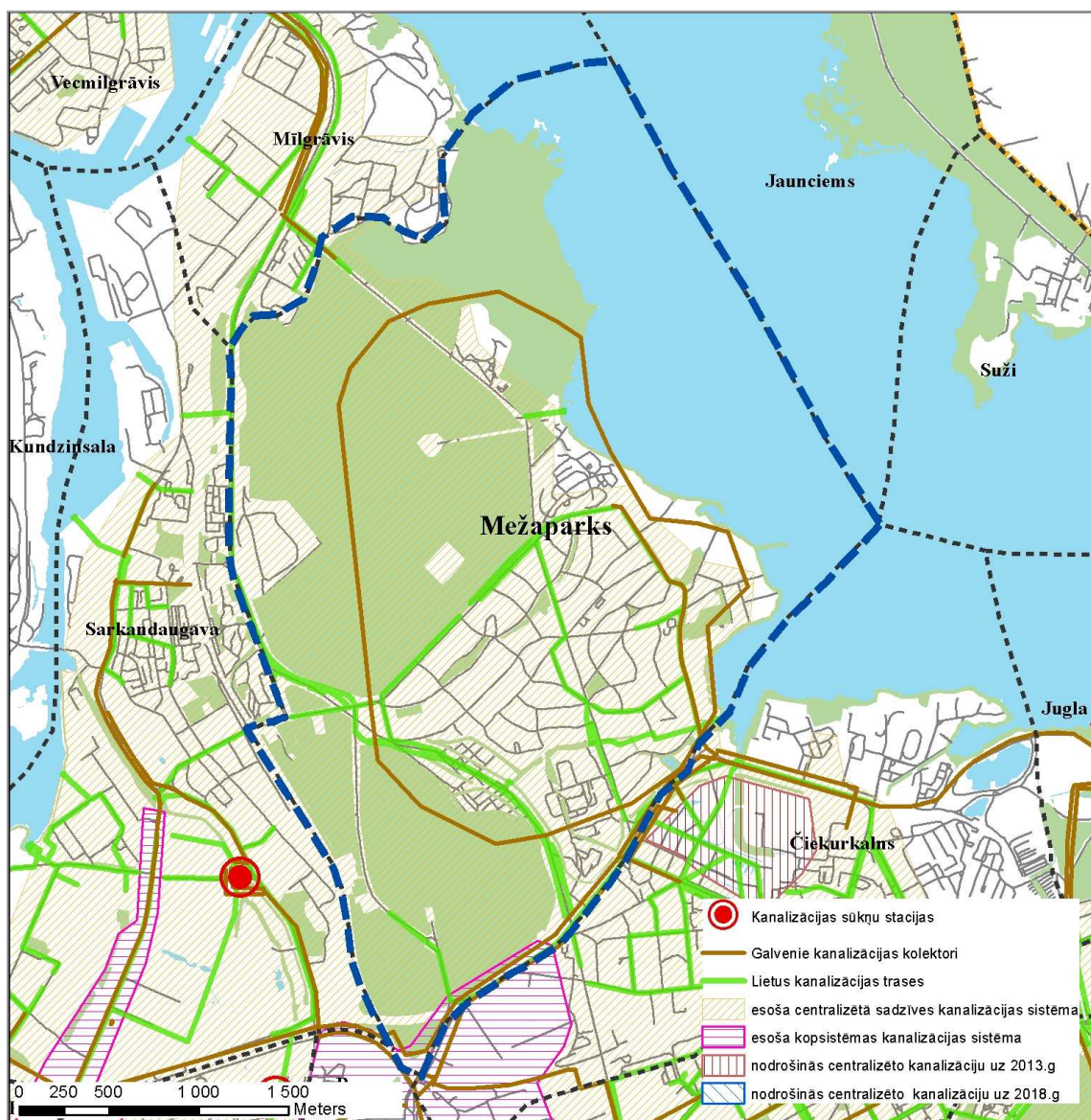
2.2.att. Nodrošinājums ar kanalizācijas apgādi apkaimē
