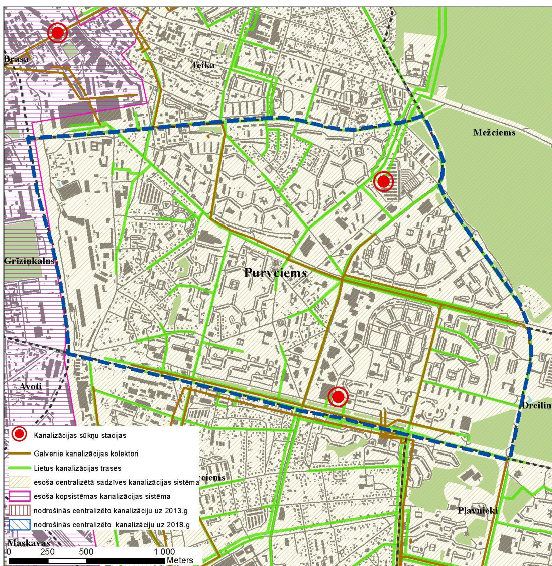
2.2.att. Nodrošinājums ar kanalizācijas apgādi apkaimē
