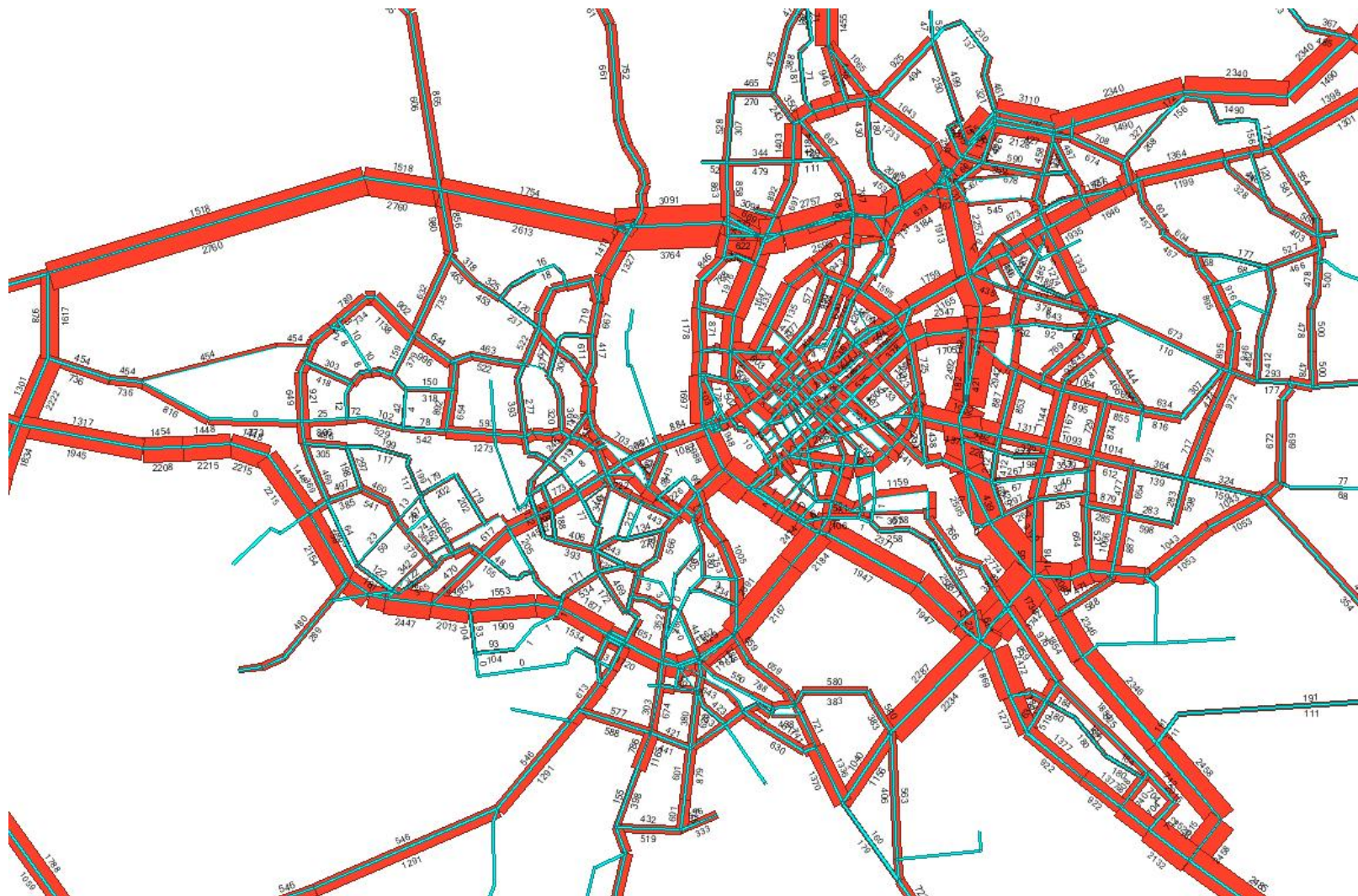
Attēls A.3a 1.scenārija 1 stundas kopējā satiksmes intensitāte rīta perioda maksimumstundā 2021.gadā (centrālā teritorija)
