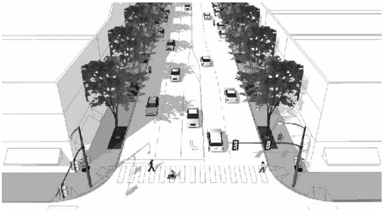
Avots: Claire Vlach, Bottomley Design & Planning. Attēls 39. Ilustratīvs ielas piemērs ar izdalīto kreiso pagriezienu RVC teritorijai.
