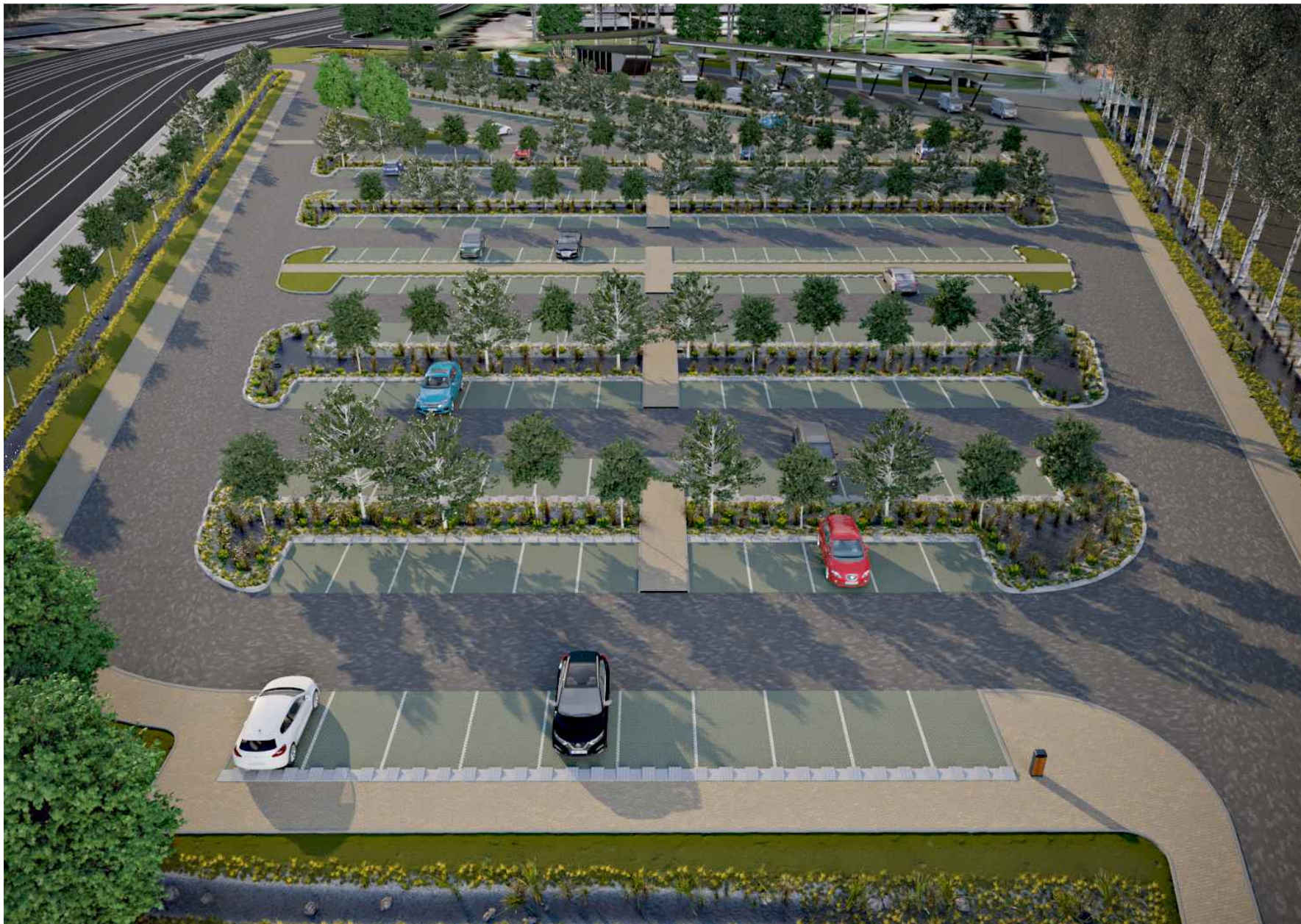
Skats uz viena līmeņa būves autonovietnēm ar ilgtspējīgiem lietus ūdens novadišanas risinājumiem un integrētu apstādījumu un labiekārtojuma infrastruktūras izveidi.
